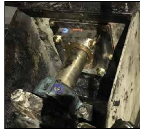
AM Rotor verwendet eine Drossel, welche die Welle umfasst und sich innerhalb der Dichtung mitdreht.
