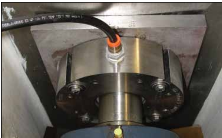
Der Inpro/Seal Air Mizer aus Edelstahl für Lebensmittelanwendungen ist eine permanente Wellendichtungslösung, die alle FDA-Anforderungen erfüllt.
